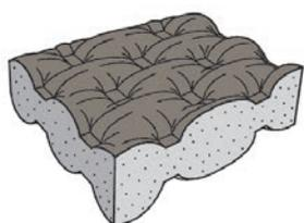
上下二層の繊維をドロップステッチ状に織り、一層の部分をなくした遮水型マットです。
