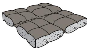
剛タイプであるFP型やNF型マットに縫製加工でタテ、ヨコに一層部を形成してブロック化し、強靱なロープで接続したものです。
