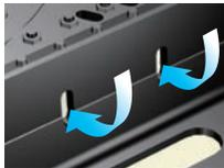
舗装が排水性舗装の場合には、浸透してきた雨水を側面の集水孔から集水します。
