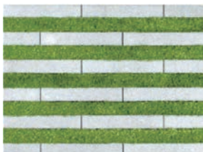
芝幅50mm張り(緑化率:約50%) ※設計上耐荷重:車両総重量14t
