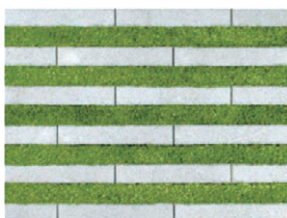
芝幅50mm張り(緑化率:約50%) ※設計上耐荷重:車両総重量14t
