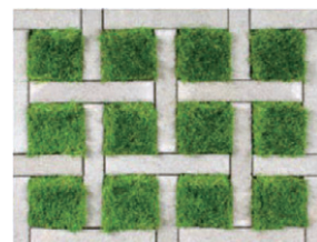
格子張り(緑化率:約51%) ※設計上耐荷重:車両総重量8t
