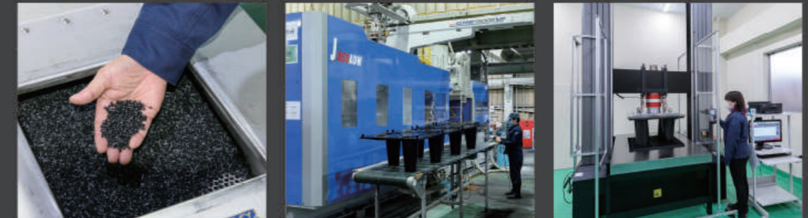
▲ 造粒機によるペレット製造 ▲ 大型成型機によるインジェクション成型 ▲ インストロン社製600kN試験機
