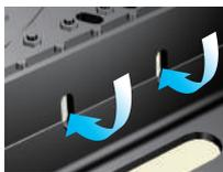
舗装が排水性舗装の場合には、浸透してきた雨水を側面の集水孔から集水します。
